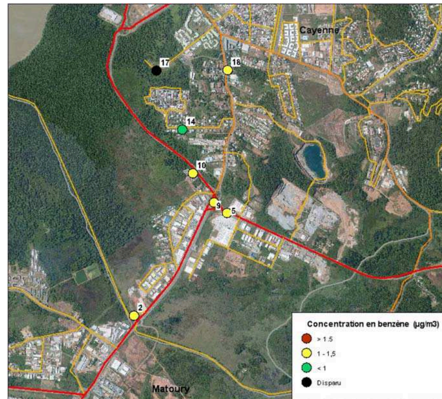
Figure 35 : Cartographie des résultats en benzène (en \mu\text{g}/\text{m}^3 ) pour la campagne de mesures de novembre/décembre 2012
